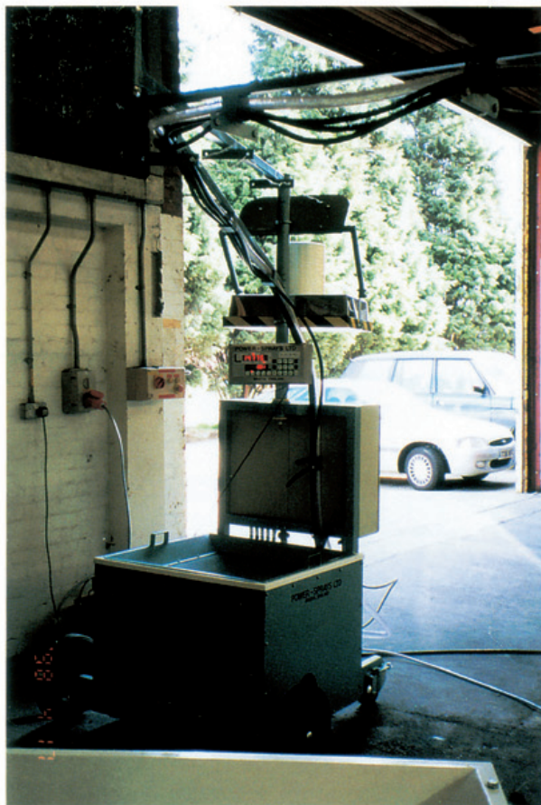
写真-1 繊維量を自動計測するダイレクトスプレー装置
