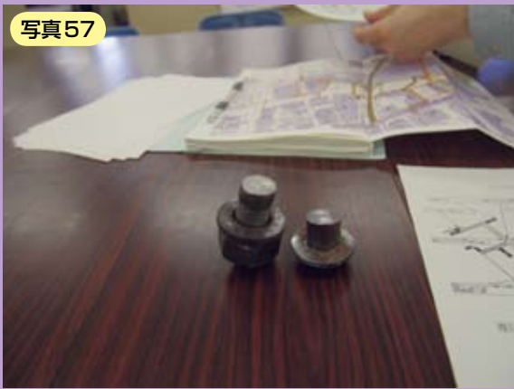
仙台駅前ペデ エクスパンション部のボルトの破断（仙台市調査結果）
